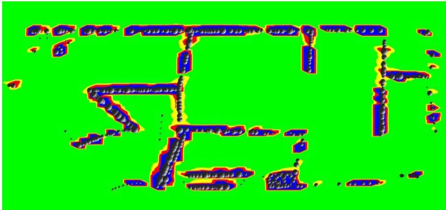
Abbildung 9: Darstellung der in Quartier nutzbaren Energiepotenzials aus Solarstrahlung 9m über Boden (grün markiert Flächen ohne Nutzungseinschränkung)
