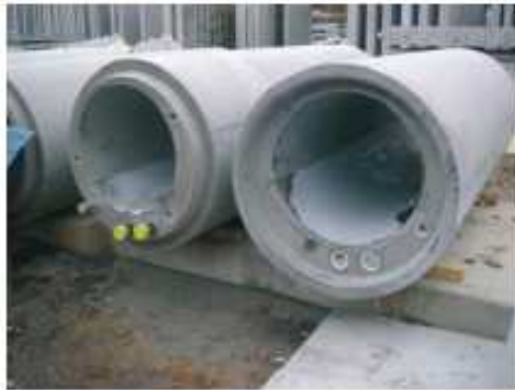
Bild 9: Kanalrohr mit Wärmetauschern in Längsrichtung. (Fotos: KOBEL, B. Ryser Ingenieure AG; SCHMID, F. eam)
